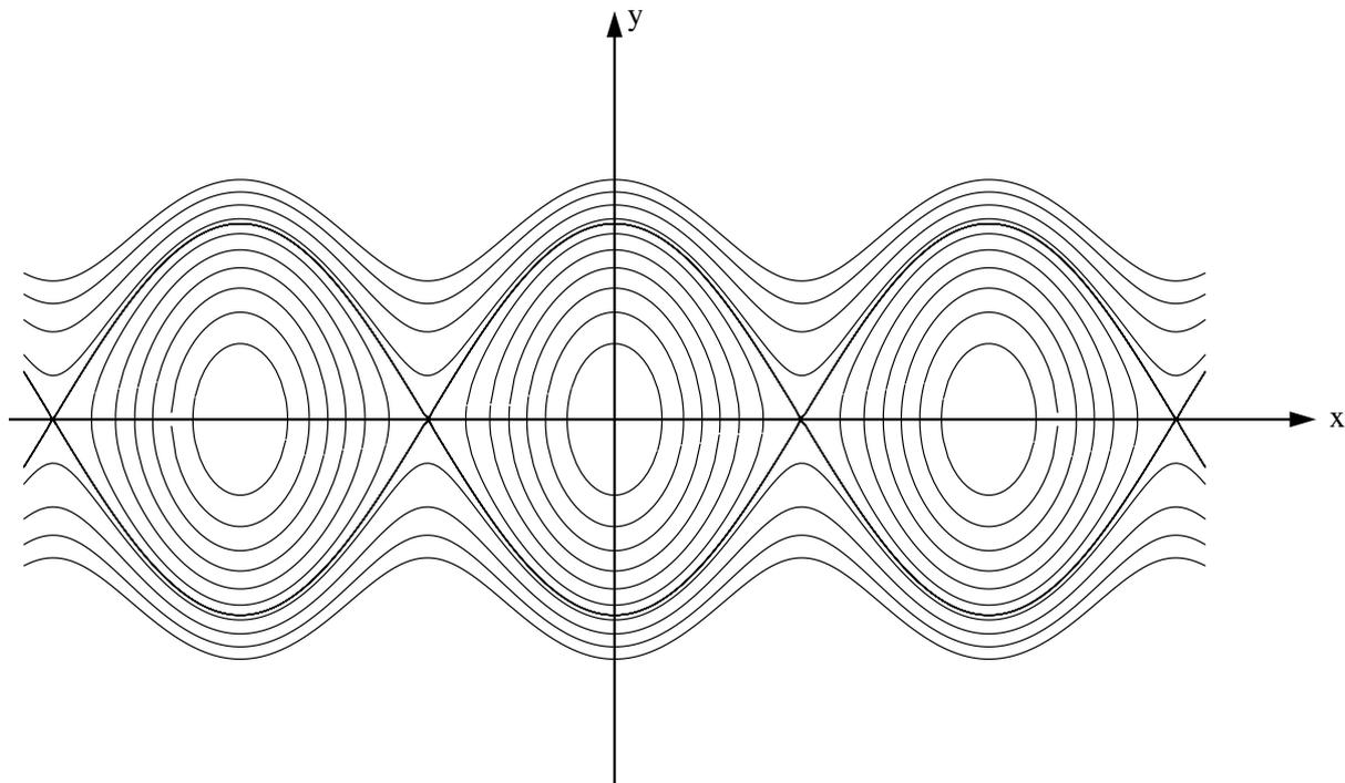
Fig. 22 - Diagramma di fase del pendolo semplice
