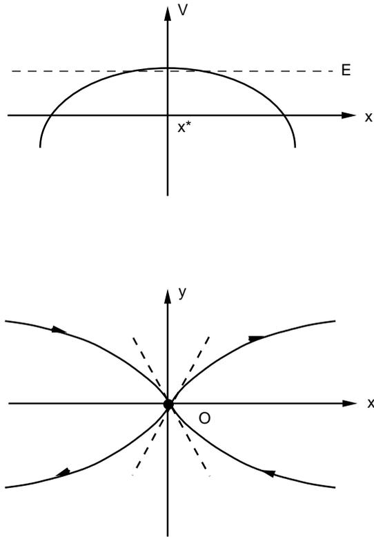
Fig. 10 - Curve di livello ell'energia in corrispondenza a un massimo di  $V(x)$  - Caso  $E = V^*$
