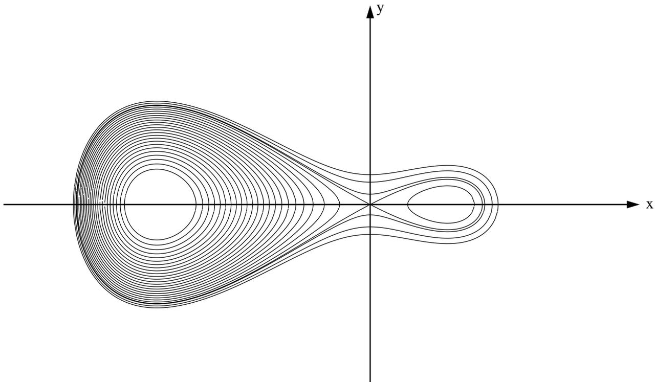
Fig. 20 - Diagramma di fase con due centri stabili e un punto di sella instabile alternati
