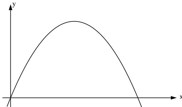
Figura DP. 1: traiettoria di un grave in assenza di resistenza del mezzo
