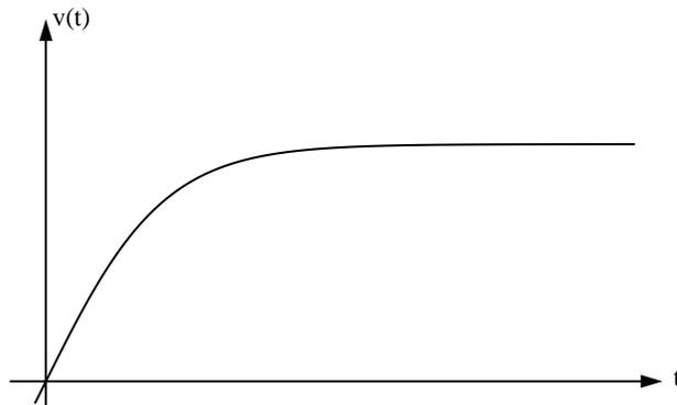
Figura DP. 4: andamento asintotico della velocità del paracadute
