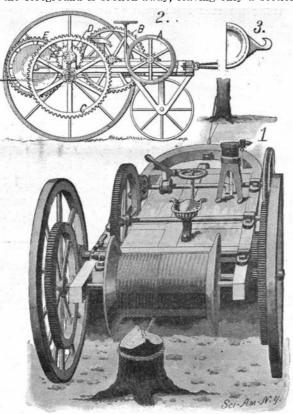
MOTOR-DRIVEN STUMP PULLER.
