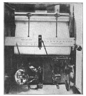
TOP PLAN VIEW OF THE RECORDER, SHOWING THE DRUMS FOR RECORDING THE MILEAGE PER HOUR AND THE POUNDS PER SQUARE INCH.
