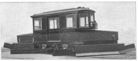
A TYPICAL SNOW PLOW USED ON THE ELECTRIC ROADS OF THE EXTREME NORTHWEST.
