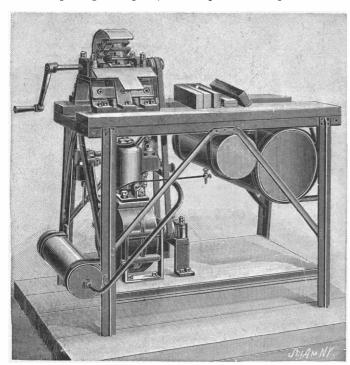
Fig. 1.—GASOLINE TRIMMING MACHINE FOR WOODEN PAVING BLOCKS.
