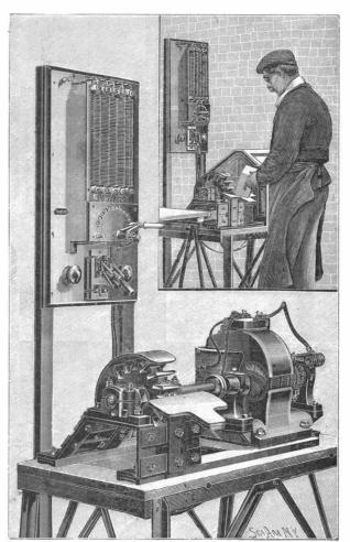
Fig. 2 -ELECTRIC TRIMMING MACHINE.
