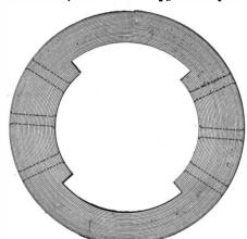
Fig. 1.—FIELD MAGNET CORE.
