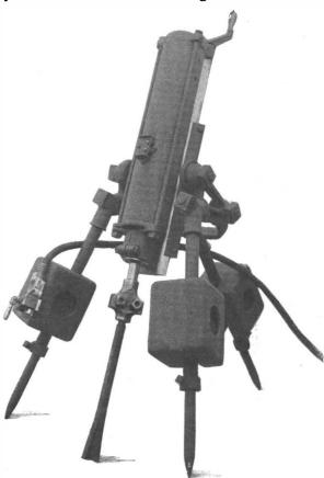
Fig. 1.—THE MARVIN ELECTRIC ROCK DRILL.
