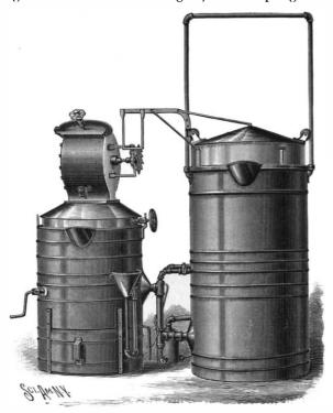
AN AUTOMATIC ACETYLENE GAS GENERATOR
