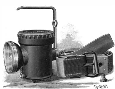
Fig. 2.—ELECTRIC LAMP FOR THE USE OF MINERS.
