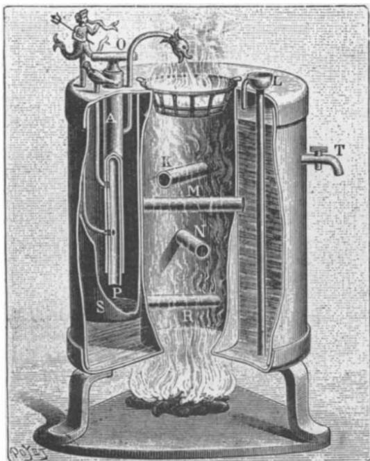
**Fig. 1.—HERON'S TUBULAR BOILER.**
