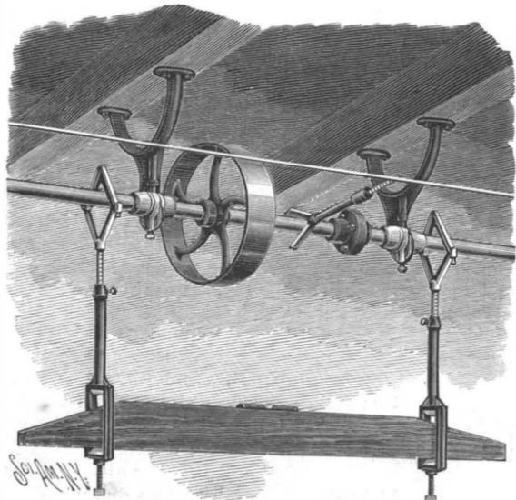
ISGRIG'S SHAFT ALIGNING DEVICES.
