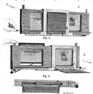
Fig. 3. SIMPLE SLIDE CHANGER AND ECLIPSER.
