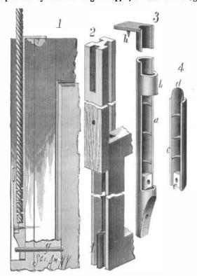
SASH CORD FASTENER AND WINDOW SASH.
