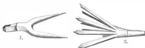
Fig. 29.—1. Soc à fourche pour arracher les Betteraves. 2. Griffe à arracher les pommes de terre.
