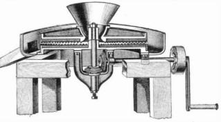
FIG. 7.-GUARDIOLA'S COFFEE HULLER FOR HAND POWER.
