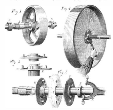
TAPER SLEEVE PULLEY AND WHEEL FASTENER.
