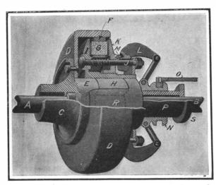
COMBINED FRICTION AND JAW CLUTCH.
