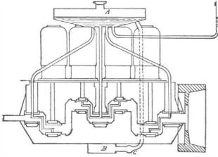
Fig. 4.—GRAVITY FEED OILING SYSTEM.
