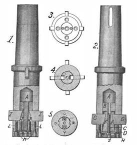
EXPANSION CUTTER-HEAD FOR BORING BRASS.
